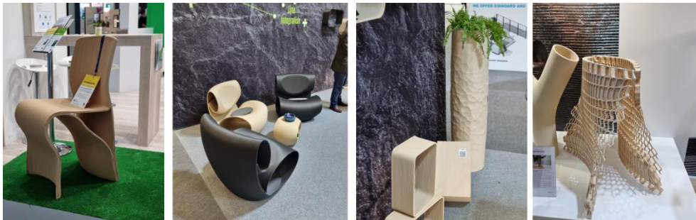
Ilustración 29 Piezas de gran tamaño producidas por tecnologías de extrusión de polímeros de gran formato. Fuente: FORMNEXT
