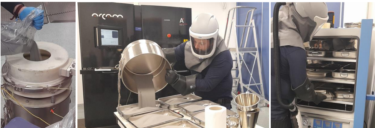
Ilustración 2. Preparación del polvo de titanio nanomodificado
